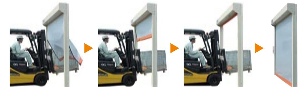
万ーシートに接触すると、シートがガイドから外れて破損を防止。外れたシートは上昇することで自動的にガイドに納まる構造。さらにファスナーへの自動注油機構がシートのスムーズな開閉と耐久性を飛躍的に向上しました。事故による開放時間をなくし、修理の手間や費用を抑えます。
